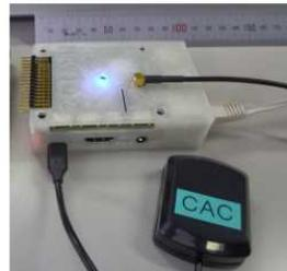
汎用シングルボードコンピュータとセンサーボードを組み合わせ、機内に持ち込んで飛行データを取得
